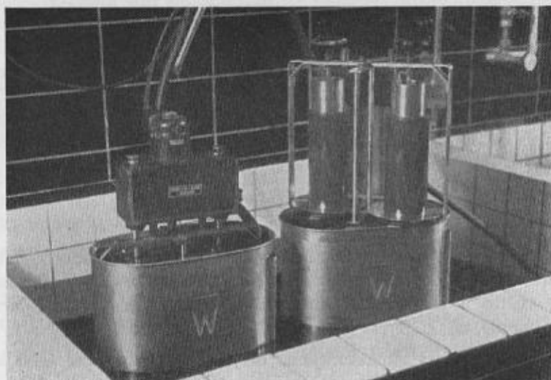
Obr. 2. Vypírání leteckého filmu pomocí převíjecího motorku
