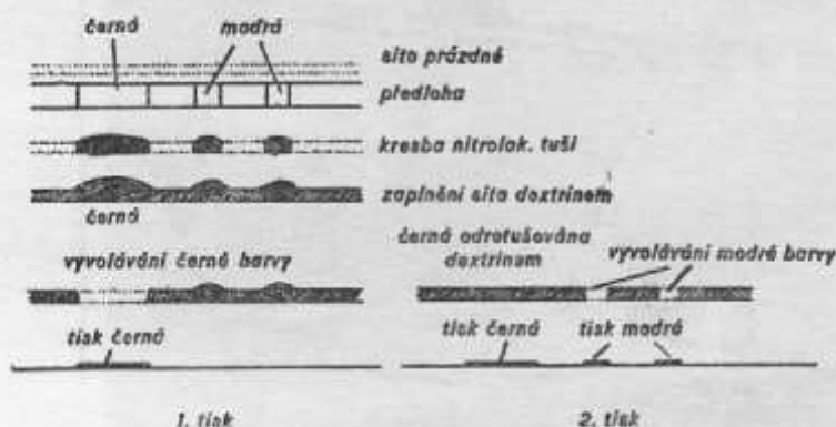
Obr. 8. Grafické znázornění postupu přípravy tiskové matrice přímým nakreslením pomocí nitrolakové tuše. Postup tisku dvou barev z jedné matrice.
