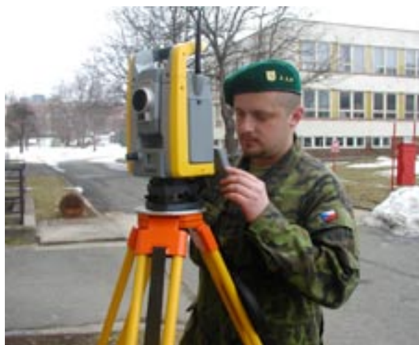
Obr. 3 Totální stanice Trimble S6
