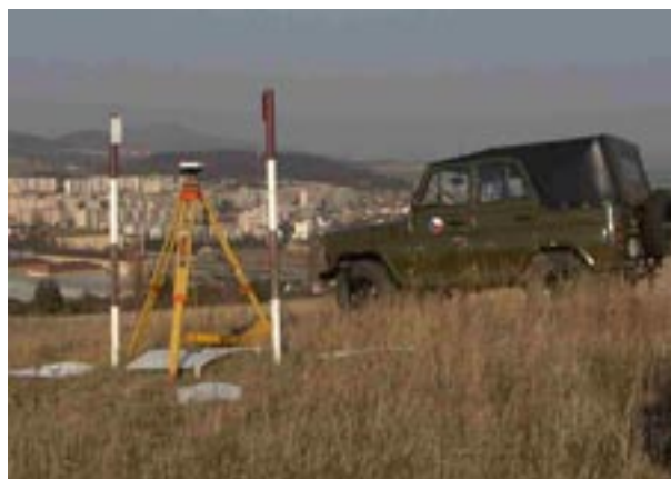
Obr. 1 Statická a rychlá statická metoda – základní metody GPS pro geodetické účely v AČR
