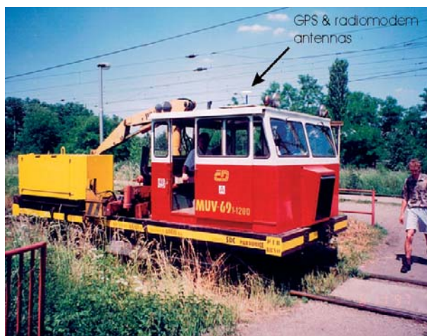
Obr. 5 Instalace systému GPS na drezině
