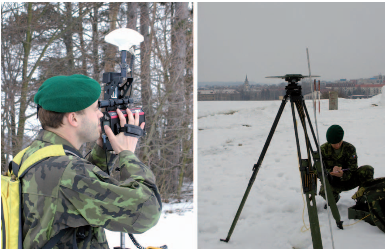
Obr. 9 Měřické práce s využitím technologie GPS (foto archiv VGHMÚř)
