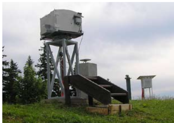
Obr. 2 Automatická bolidová kamera na stanici Polom
