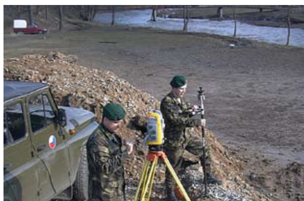
Obr. 8 Využití totální stanice Trimble S6 při geodetickém zabezpečení výstavby náhradních mostních provizorií
