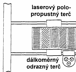
Obr. 5 Schéma předního navigačního terče
