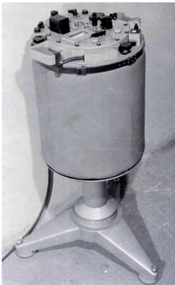
Obr. 1 Gravimetr Askania Gs12
