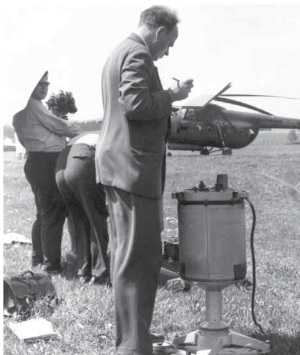
Obr. 5 Ing. Z. Šimon, DrSc., a Ing. L. Träger, CSc., při tíhovém měření na HGZ na bodu Dolní Dvořiště s využitím letecké přepravy
