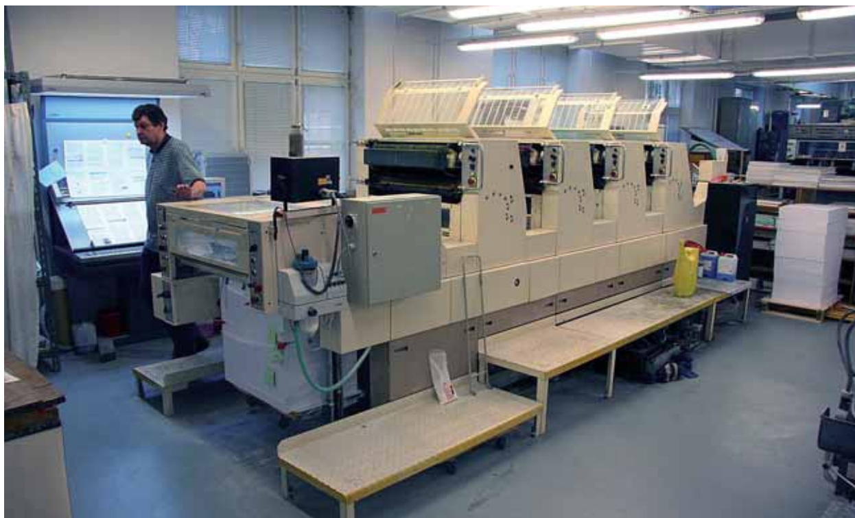
Obr. 1 Tiskový stroj POLLY 745, Oddělení ofsetového tisku v Praze
