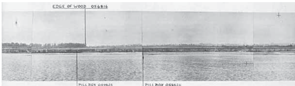
Obr. 11 Snímek pro pozemní fotogrammetrické vyhodnocení terénu pobřeží Normandie
