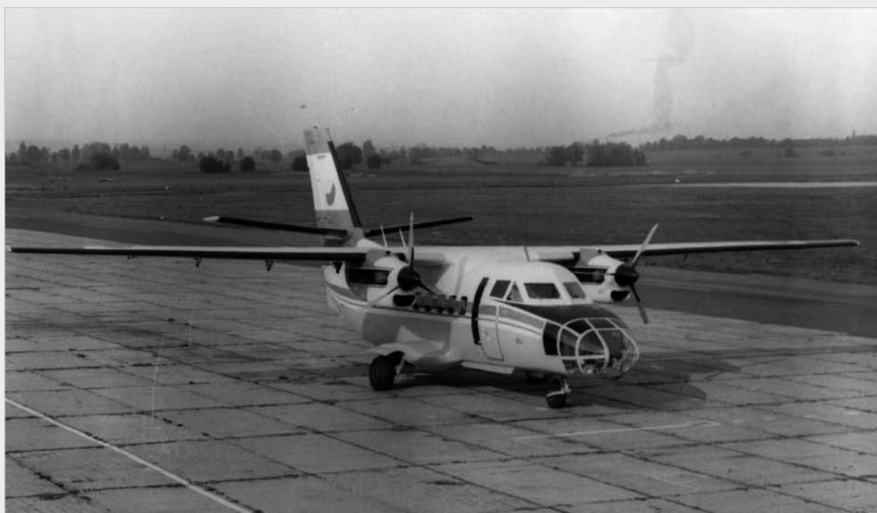
▲ Od r. 1985 bylo letecké snímkování pro potřeby topografického mapování prováděno novými letouny L-410 FG (na snímku), které u FLS postupně nahradily letouny IL-14 FG.
