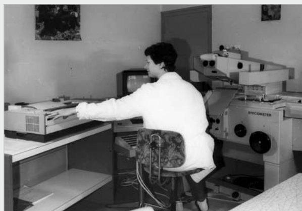
▲ Přístroj ke stereoskopickému měření snímkových a horizontálních parallax bodů zobrazených na snímkové dvojici – stereokomparátor STECOMETER C.
