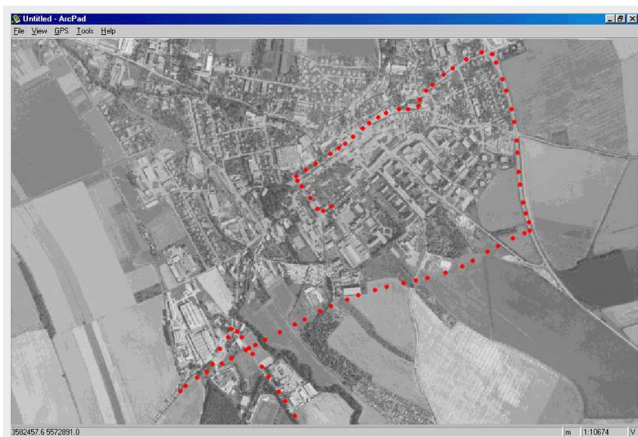
▲ Zaměření silničního obchvatu Dobrušky metodou GPS.
