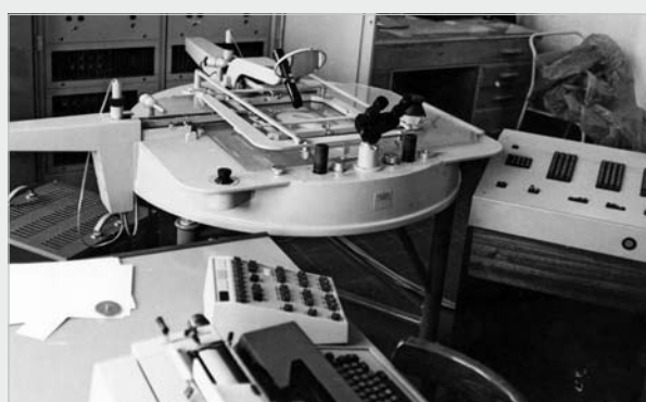
▲ Monokomparátor ASCORECORD pro měření snímkových souřadnic.
