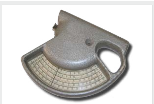
▲ Dendrometr – přístroj používaný k určování relativních výšek předmětů.
