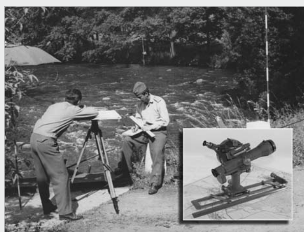
▲ Mapovací práce prováděné metodou stolové tachymetrie a eklimetr autoredukční KERN RK (r. výroby 1950), používaný ve VTOPÚ ke stolové tachymetrii.
