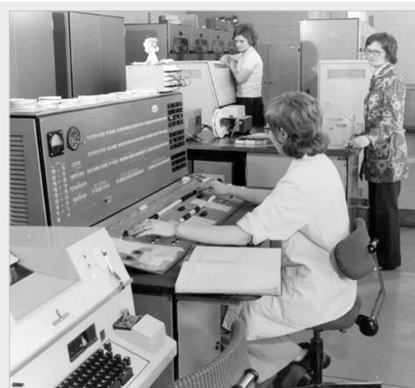
▲ Pracoviště operátora sálového počítače MINSK 22.
