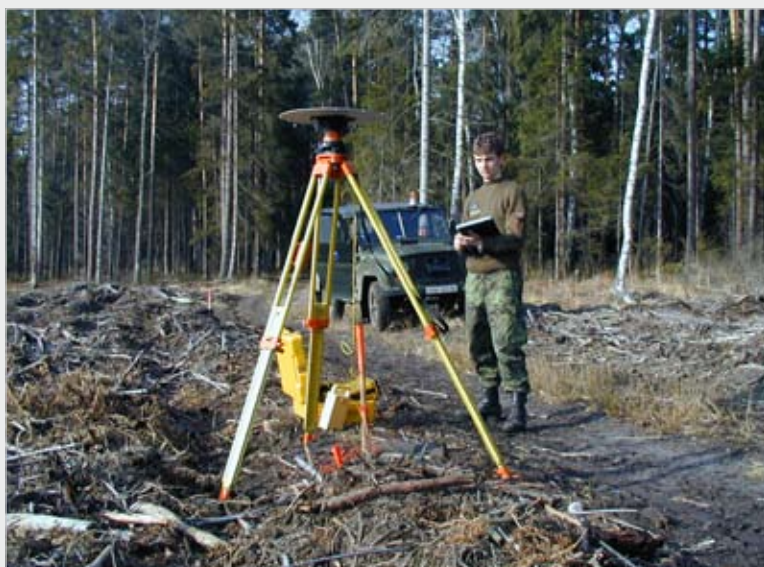
▲ Využití přijímače GPS Trimble 4000SSi při plnění úkolu geodetického zabezpečení pyrotechnických asanací.
