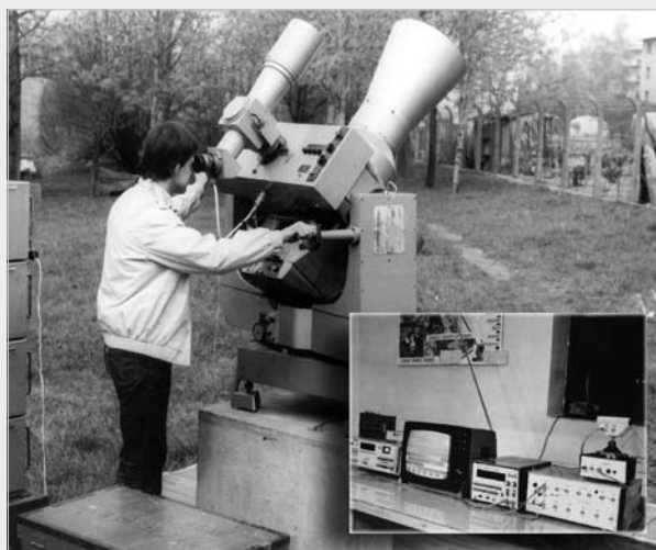
▲ Komora pro fotografické observace umělých družic Země AFU75.
