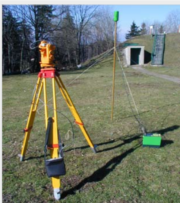
▲ Nemagnetický teodolit s magnetickou sondou a protonový magnetometr PMG-1.
