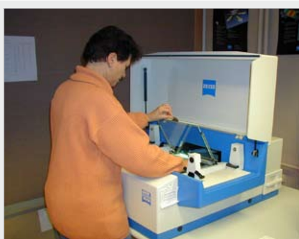
▲ První fotogrammetrický skener PCSCAI od firmy Zeiss pořízený pro Vojenský topografický ústav.
