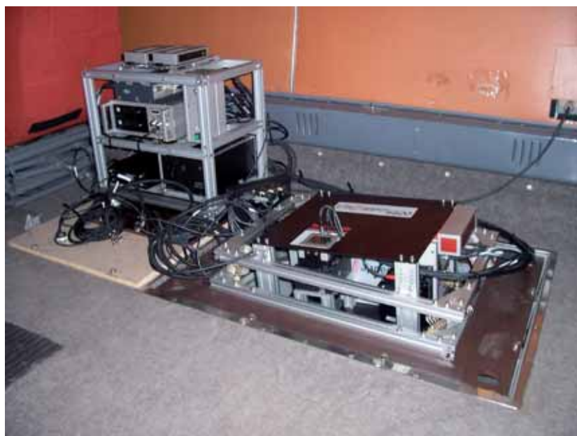
Obr. 2 Letadlo Turbolet L-410 FG a skenovací systém LiteMapper 6800 na jeho palubě
