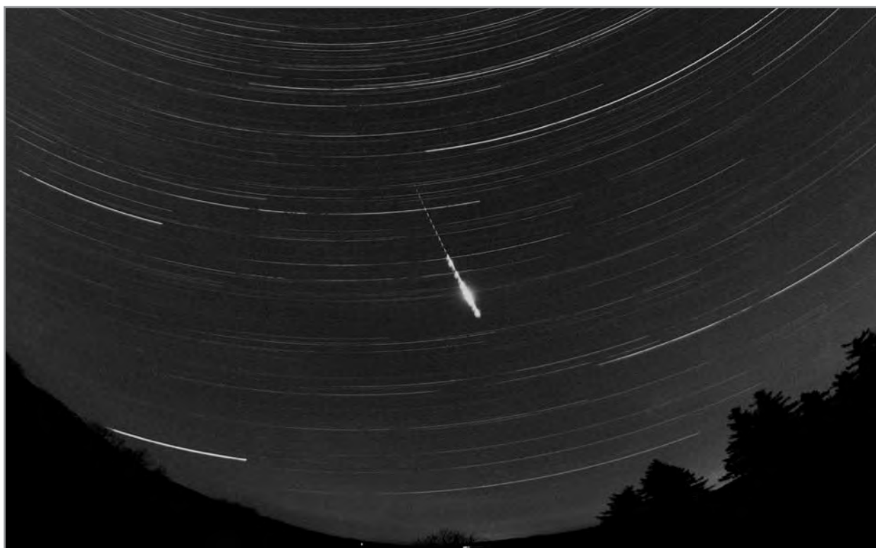
Obr. 5 Světelná stopa bolidu EN110408 zachycená automatickou bolidovou kamerou na stanici Polom; přerušování stopy je způsobeno rotujícím sektorem z důvodů určení rychlosti a brždění tělesa v atmosféře (15 přerušeni/s)
