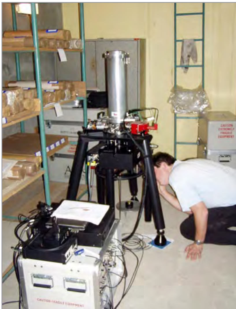
Obr. 1 Příprava absolutního gravimetru FG5 č. 215 pro měření na bodě 79 Polom
