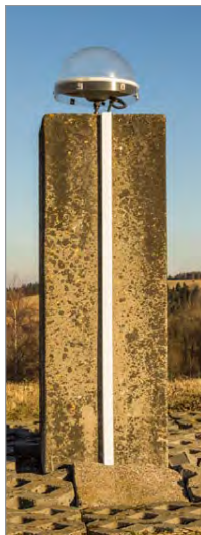
Obr. 47 Anténa Trimble Zephyr Geodetic na observačním stanovišti POL1
