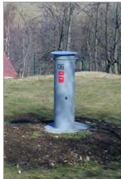
Obr. 32 Měřický bod s hloubkovou stabilizací a nucenou centrací
