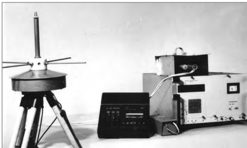
Obr. 17 Souprava dopplerovské aparatury DOG-3
