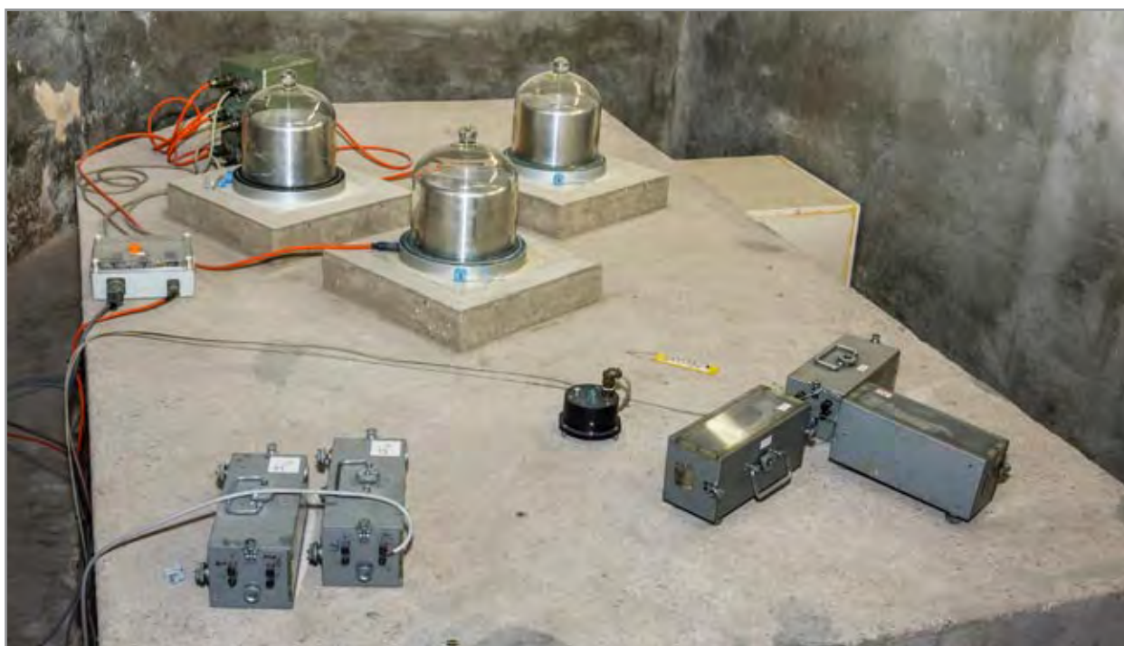
Obr. 39 Celkový pohled na pilíř se seismickými senzory (v popředí staré sovětské senzory VEGIK-M, uprostřed černý EpiSensor FBA ES-T, v pozadí senzory STS-1)
