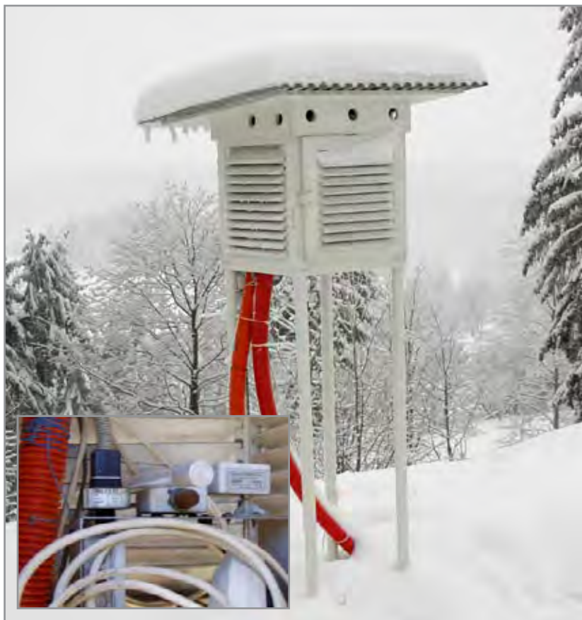
Obr. 33 Meteorologická budka na objektu pohraničního opevnění a senzory tlaku (vlevo), vlhkosti (uprostřed) a teploty (vpravo)
