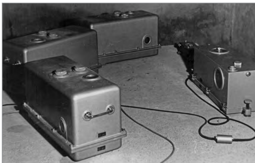
Obr. 6 Seismometry SVK-3, SVKM-3 a SGKM-3
