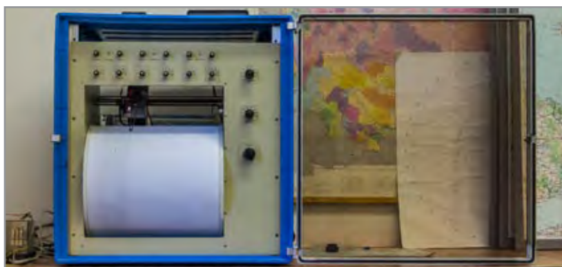
Obr. 41 Modernizovaná bubnová registrace BR95
