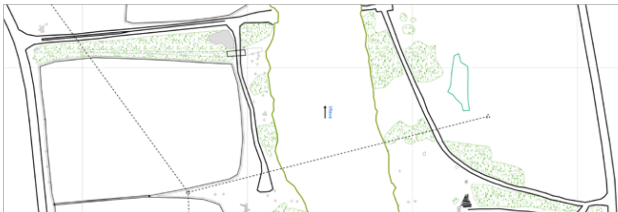
Obr. 3 Výřez velkoměřítkové mapy prostoru vhodného pro výstavbu mostního provizoria přes řeku Vltavu v lokalitě Hněvkovice (měřítko 1 : 1 000, zpracováno s využitím tachymetrických měření v systému WGS84/UTM)
