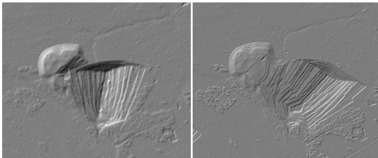
Obr. 2 Srovnání dat SRTM (vlevo) a TanDEM-X (vpravo)
