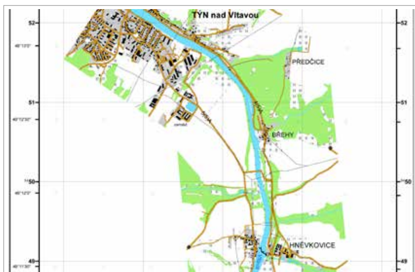
Obr. 2 Výřez účelové topografické mapy 1 : 25 000 zobrazující místo možné výstavby mostního provizoria a jeho okolí s důrazem na přístupové komunikace a vodní tok (zpracováno s využitím ortogonalizovaných leteckých měřických snímků, mapování technologií GNSS a místního šetření; systém WGS84/UTM)
