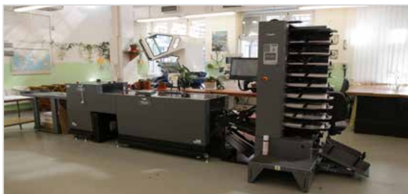
Obr. 2 Snášečící a sešívací stroj DUPLO DBM-600T
