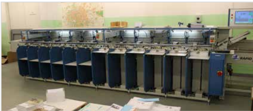
Obr. 7 Snášečí stroj MKW Rapid UT12
