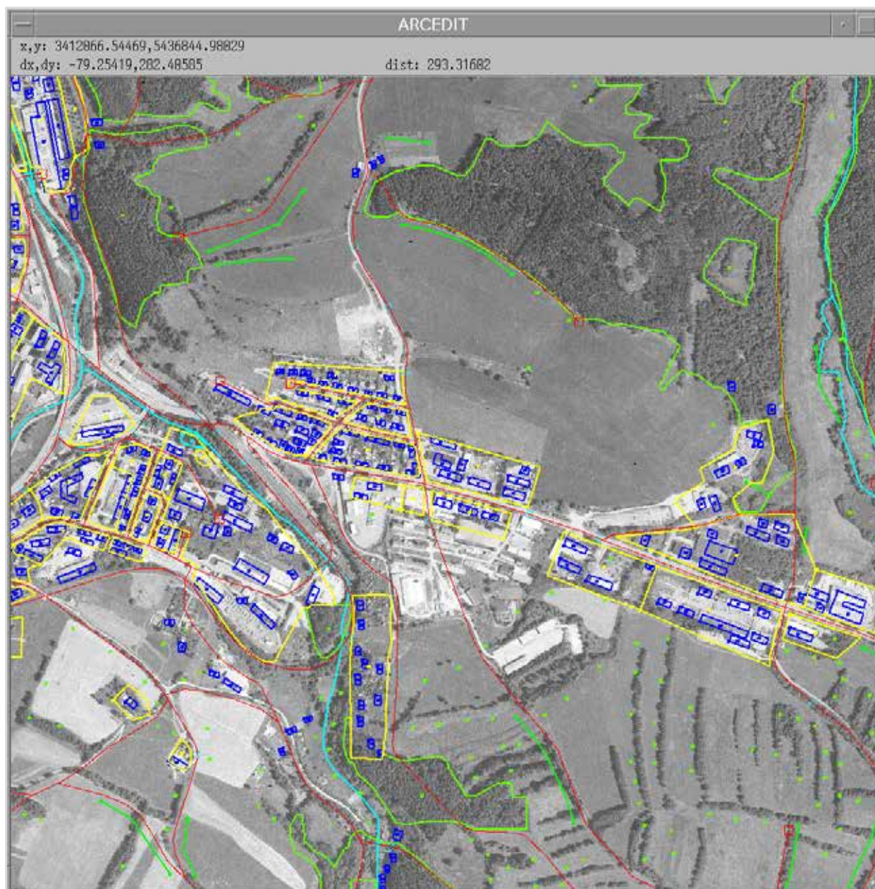
Obr. 1 Ukázka „superpozice“ ortogonalizovaného LMS a dat DMÚ 25
