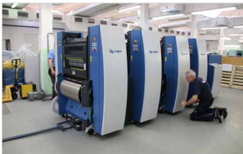
Obr. 8 Montáž a kompletní sestava tiskového stroje KBA RAPIDA 75 Pro
