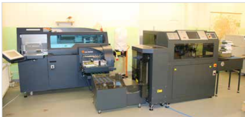
Obr. 4 Lepicí stroj BOURG BINDER 3002 (vlevo vzadu) a trojřez CHALLENGE CMT-130TC
