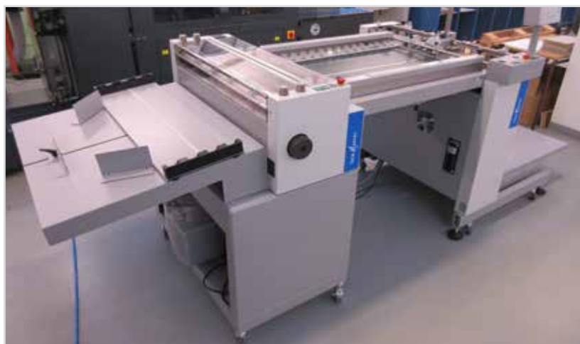
Obr. 5 Perforovací a rylovací stroj MASTERFOLD DCM-75 ST
