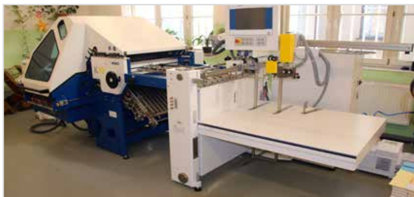
Obr. 3 Skládací stroj MBO-K70
