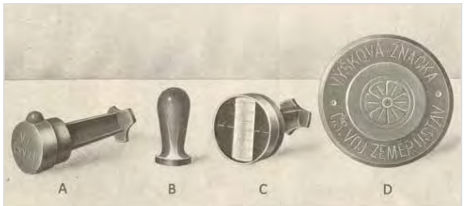
Obr. 20 Nové niveláčnické značky VZÚ navržené v roce 1921 štábním kapitánem Ladislavem Benešem – čepové (A), svorníkové (B) a čepová značka pro vědecké účely s dělenou stupnicí vyleptanou na skleněné destičce (C) opatřená ochranným krytem (D)
