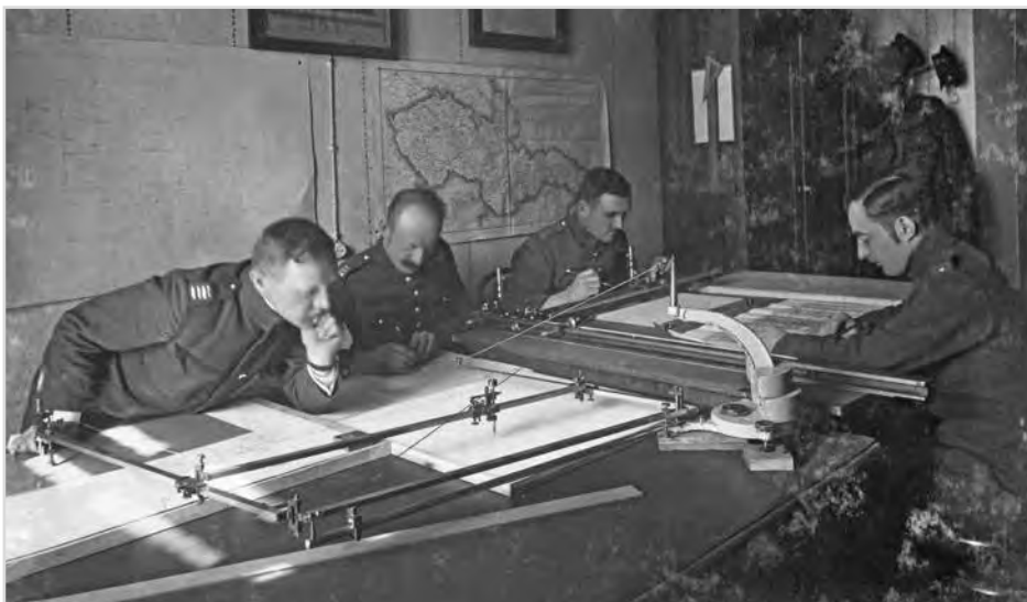
Obr. 28 Překreslování situace pomocí pantografu
