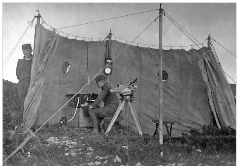
Obr. 26 Měření cirkumzenitálem Nušl-Frič na trigonometrickém bodě Kamionka
