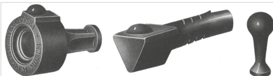
Obr. 11 Nivelační značky použité pro stabilizaci bodů
