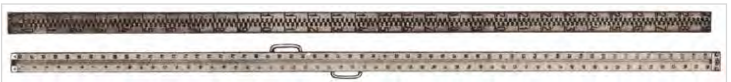
Obr. 9 Použité nivelační latě – dřevěná latě z vídeňského MGI (nahore) a nová invarová latě Zeiss (dole)
