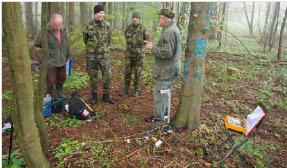
Obr. 3 Elektrická impedanční metoda pro stanovení parametrů kořenových systémů stromů (foto M. Rybanský)
