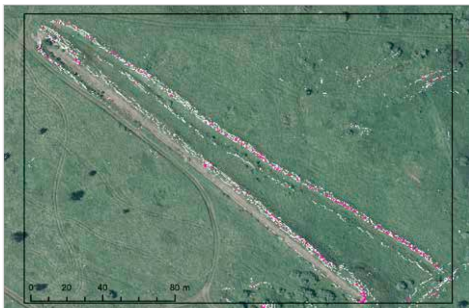
Obr. 7 Výstup modelu pro T815 mikroreliefního objektu ve VÚj Hradiště (fialové pixely představují neprůchozí terénní hranu, bílé pixely pravděpodobně překonatelnou hranu s možností kontaktu podvozku vozidla s terénem; zdroj mapového podkladu – Ortofoto © ČÚZK)
