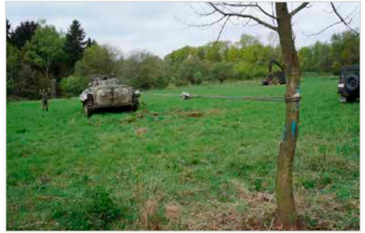
Obr. 5 Měření trakční síly BVP-2 k určení resistance stromu (javor) (foto M. Rybanský)
