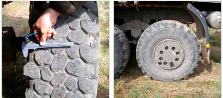
Obr. 17 Měření stavu pneumatik vozidla Tatra 810 při testech v roce 2017 (foto V. Talhofer)
