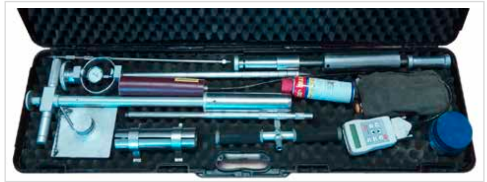
Obr. 1 Originální sada pro měření průchodnosti půd E-960, včetně nástavců navržených řešitelským týmem pro snazší manipulaci a přenosného senzoru půdní vlhkosti ThetaProbe ML3
