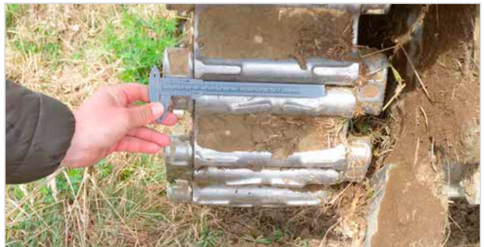
Obr. 18 Měření stavu záběrových prvků pásu vozidla BVP-2 při testech v roce 2017 (foto V. Talhofer)
