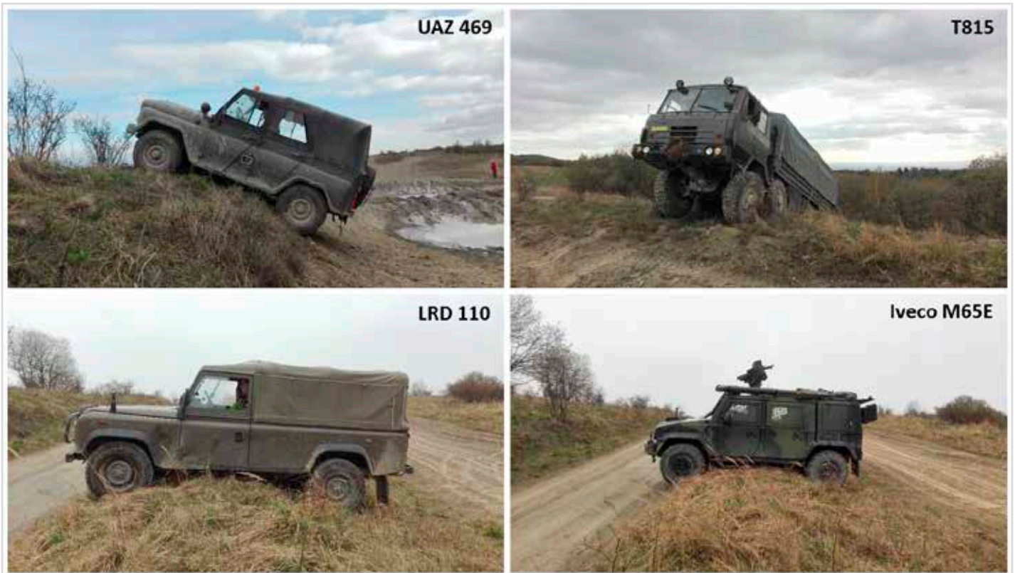
Obr. 4 Vybraná kolová vojenská vozidla během terénních testů ve VÚJ Libavá v roce 2017 – terénní stupeň (nahore), terénní val (dole)
