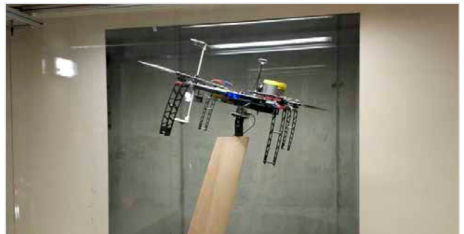
Obr. 15 Pohled na upevněnou multikopteru na vážní plošině v měřícím prostoru aerodynamického tunelu (foto J. Novotný)
