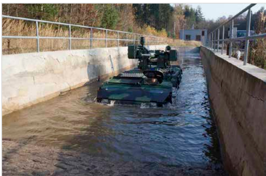
Obr. 16 Testy brodění a plavby kolového vozidla Pandur II v ZTO Podivice (foto M. Rybanský)
