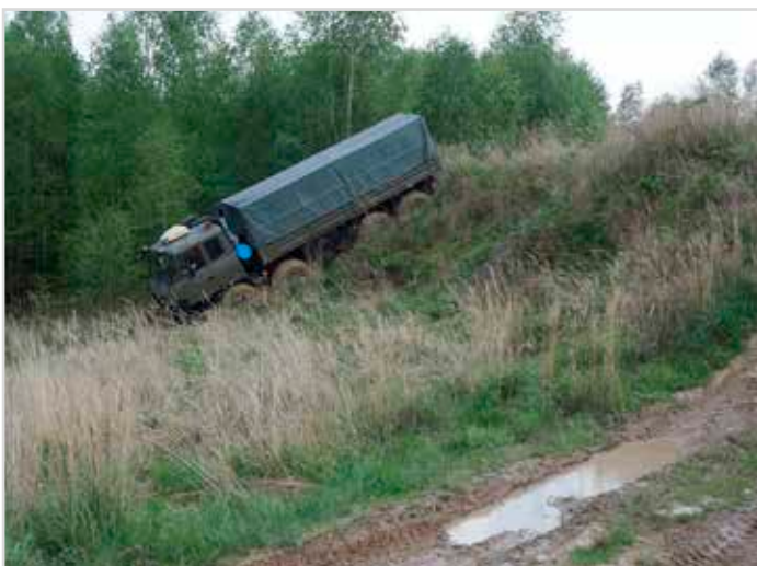
Obr. 1 Test zpomalení vlivem sklonu svahu, Centrum řízení bojových vozidel, VÚj Vyškov, 2014 (foto V. Talhofer)
