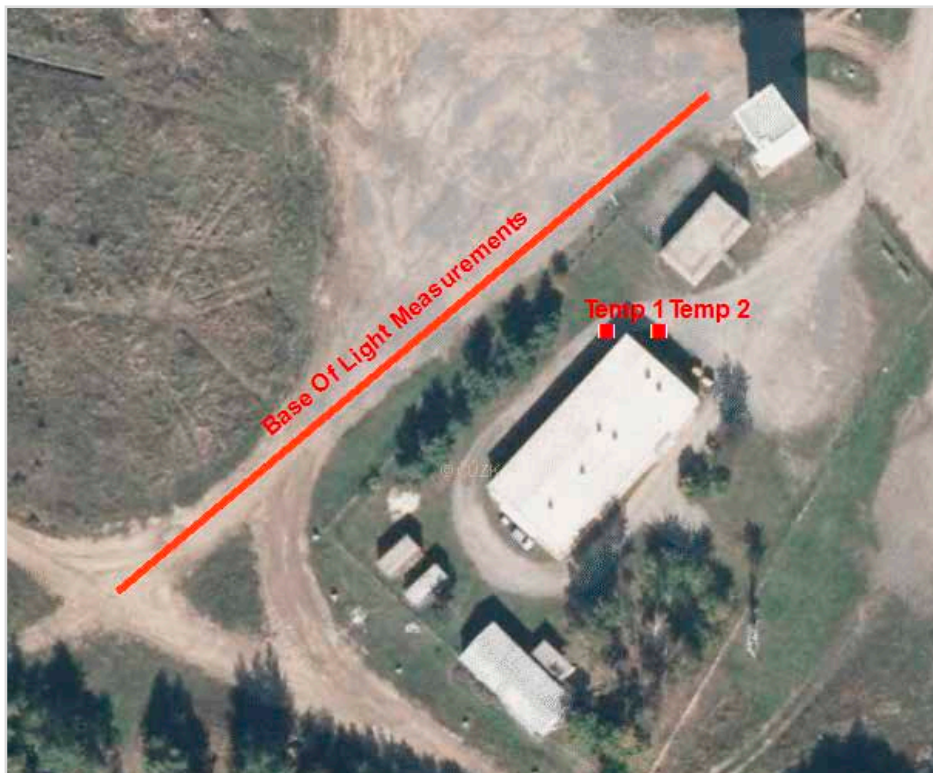
Obr. 20 Poloha měřicích bodů pro meteorologická data a základny pro měření svítivosti vnějšího osvětlení
