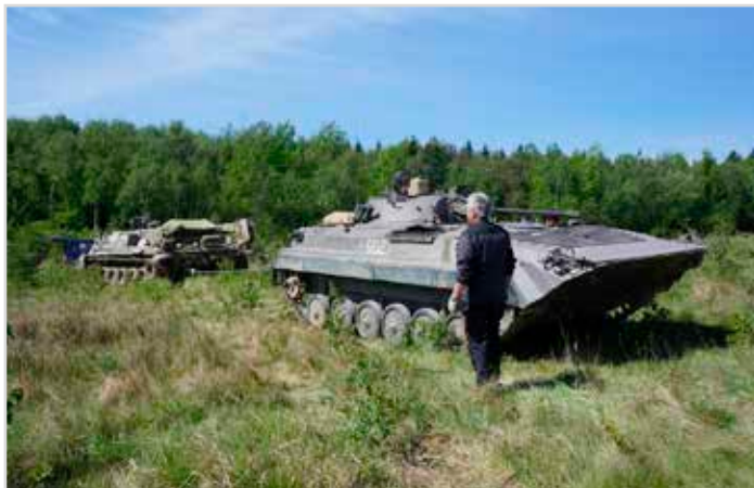
Obr. 7 Měření trakčních sil pásového vozidla BVP-2 na travnatém povrchu (foto M. Rybanský)
