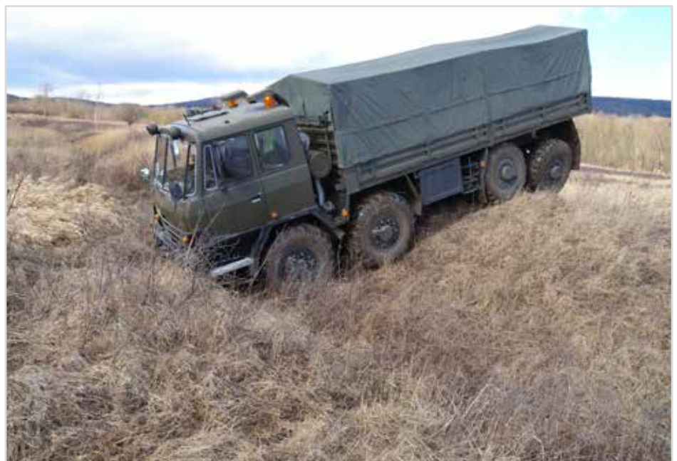
Obr. 12 Vozidlo T815 uvíznuté v terénním výkopu
