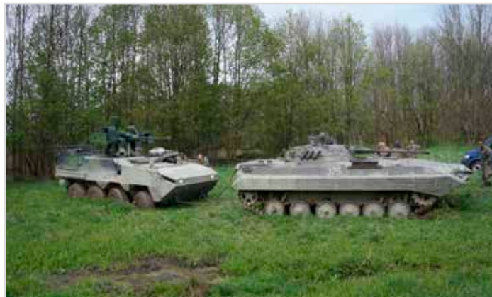
Obr. 8 Vyprošťování zapadlého kolového vozidla Pandur II pásovým vozidlem BVP-2 na bořivém podloží fluvizemě ve VÚJ Libavá, 2017 (foto M. Rybanský)
