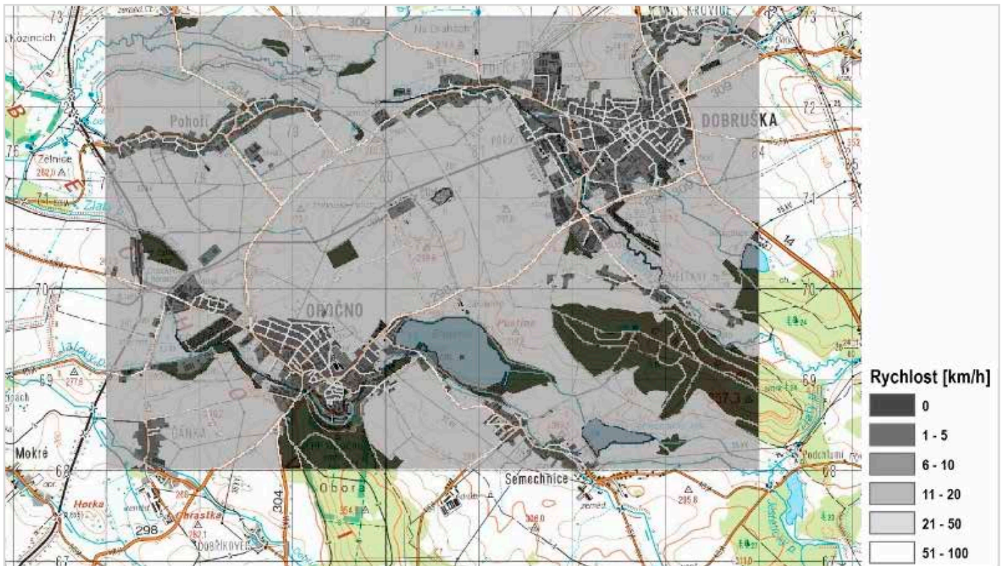
Obr. 4 Příklad výsledku výpočtu průchodnosti terénu pomocí MPT4000 (počítáno pro vozidlo Pandur II)
