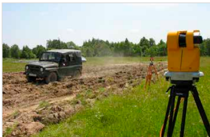
Obr. 12 Měření zpomalení vlivem drsnosti povrchu – oraniště (foto M. Rybanský)
