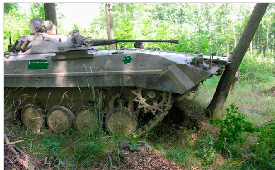
Obr. 7 Tlaková zkouška překonatelnosti stromů pásovým vozidlem BVP-2 (foto M. Rybanský)
