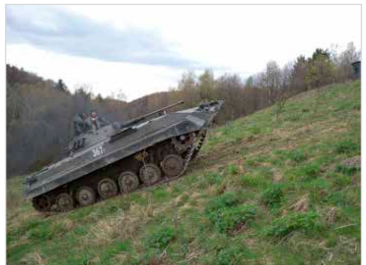
Obr. 2 Test zpomalení vlivem sklonu svahu ve VÚj Libavá, 2017 (foto V. Talhofer)
